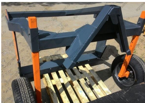
Рисунок 2 – Навесные свеклоподъемники СНУ-3С (Скоба)
