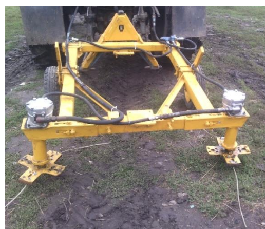
б) ротационный 4х рядный ботвоизмельчитель
