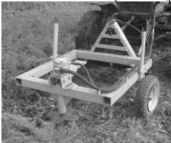
Рисунок 1 - Общий вид разработанного ботвоизмельчителя БИР-2
