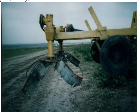
а) ротационный ботвоизмельчитель, переоборудованный для скашивания ботвы сахарной свеклы
