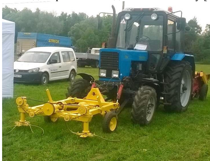
Рисунок 1 – Комбинированный агрегат для измельчения растений и заделки их в почву
